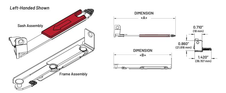
«D» Minimum Sash Length = «A» W.O.C.D. Length + «C» Window Hinge Length
